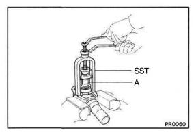
(d) Using SST, push out the bearing from the flange. SST 09332-25010
